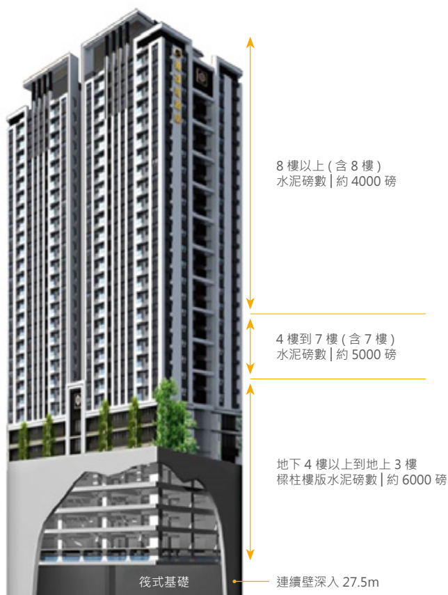
台南遠雄新源邸結構基礎設計
