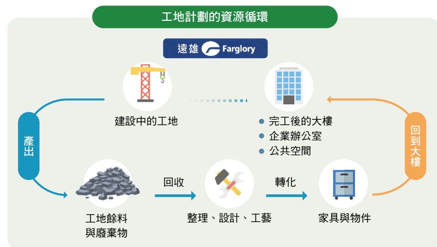
▲ 建材餘料經由設計，轉化為可應用於大樓的家具及建材。當大樓已達使用年限，拆除的廢棄建材亦可透過轉化再次應用於新建大樓。
