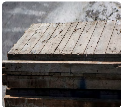
▲ 退役的木模板，經過拔除鐵釘、磨皮、膠合及設計組裝，重塑為共享區桌面、吧檯椅及流理檯面等木製家具。
