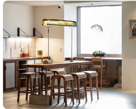
▲ 退役的木模板，經過拔除鐵釘、磨皮、膠合及設計組裝，重塑為共享區桌面、吧檯椅及流理檯面等木製家具。
